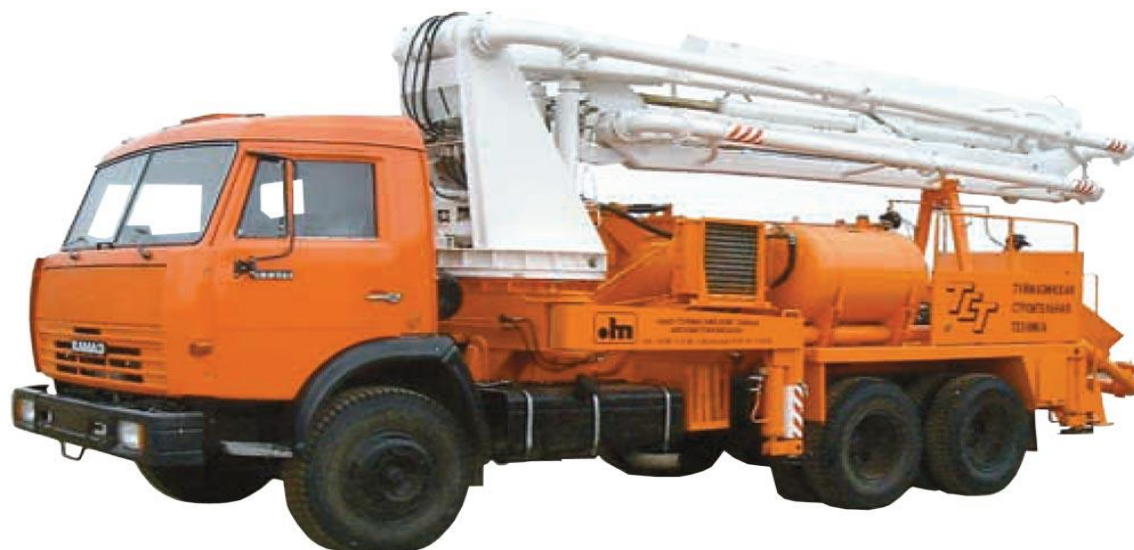
Рисунок И.2 Автобетононасос 58152А
